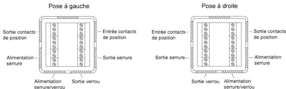
**Important** : bien respecter les polarités en mode émission. Les câbles d'alimentation et de sortie contacts de position doivent être de catégorie C2. Les presse-étoupes admettent des diamètres de câbles compris entre 7 et 10.5 mm.
