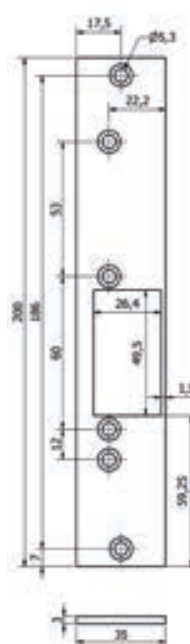
Tête de EASY MOUNTING inox droite, Modèle bouts carrés ou ronds
